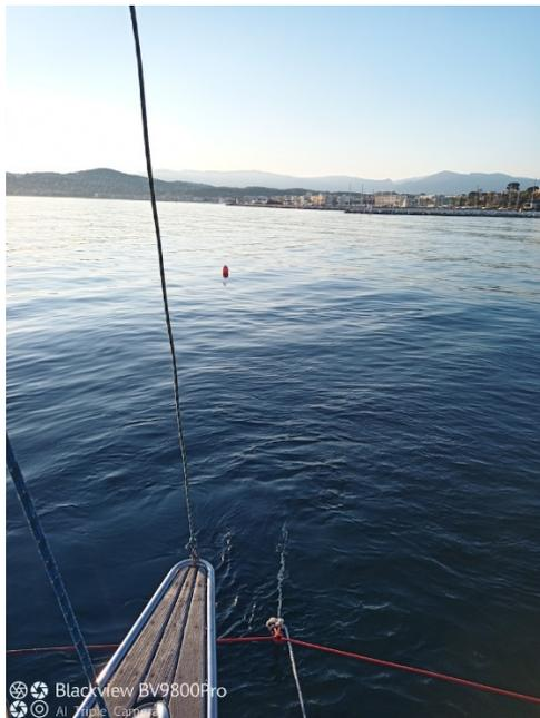
Comme tout le monde, patte d'oe obligatoire, un bout de 12mm (par-ce que j'en ai un de disponible), pas nécessairement élastique, partant d'un taquet d'étrave de la coque au pontet d'un flotteur, puis via une boucle revient au pontet de l'autre flotteur et au deuxième taquet, le câblot (lui nécessairement élastique) et fixé sur ce bout et plonge loin devant.
