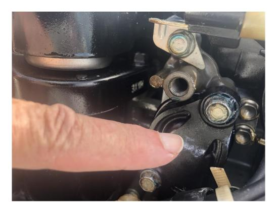
Enlever les 2 boulons. Retirer la plaque. Attention à ne pas abîmer le joint de la plaque.
